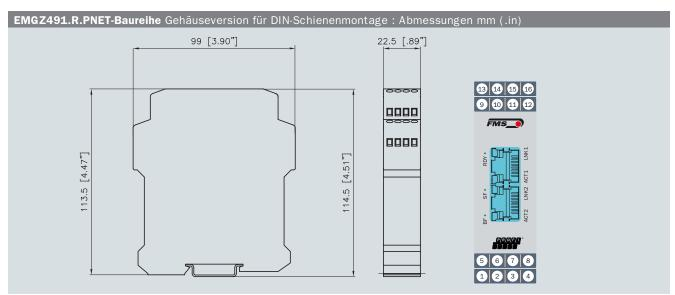
Anschlüsse über RJ45 und abnehmbare Klemmenleisten (IP 20).
