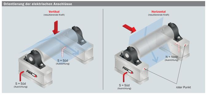
Ansicht mit zwei Kraftaufnehmern mit Anschluss S = Süd. Die Version "Vertikal" hat keinen roten Punkt.
