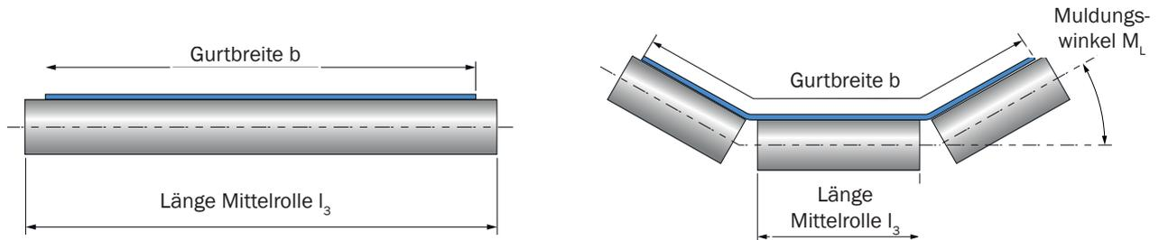
**Messrollen : Verstellmöglichkeiten bei Montage**
